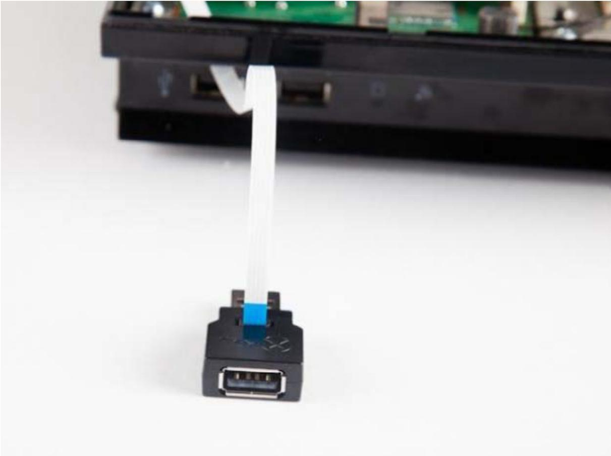
17. Brancher l'adaptateur USB dans l'une des fiches USB de la console en face avant.
