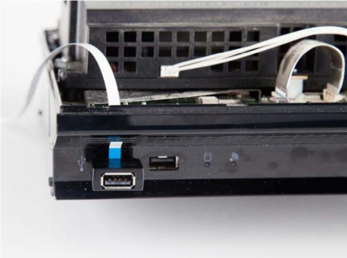
18. Connecter l'extrémité de la nappe souple 4 contacts sur le connecteur 3k3y marqué USB. La nappe souple devra être placée soigneusement et maintenue avec du scotch. Note : le plastique de renfort bleu se trouvant sur la nappe doit être visible.
